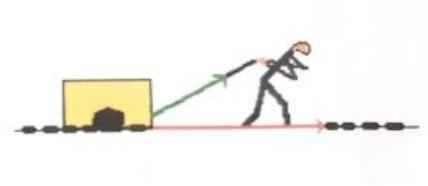
**Principe :** En physique, on modélise les « forces » s’exerçant sur un objet par un vecteur : il est caractérisé par sa direction, son sens, et sa longueur dépendant de la valeur de la force.
